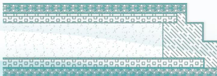
Il valore di abbattimento acustico è stato calcolato modellizzando il pannello secondo il D.P.C.M. del 5 Dicembre 1997, in cui si è assunto il valore di abbattimento acustico certificato del **VPanel by FFT** pari a 40dB con spessore 38mm ed interpolando per ottenere 37dB con spessore 25mm. A tutto è stato aggiunto un incremento del potere fonoisolante dovuto al rivestimento misto pari a:
